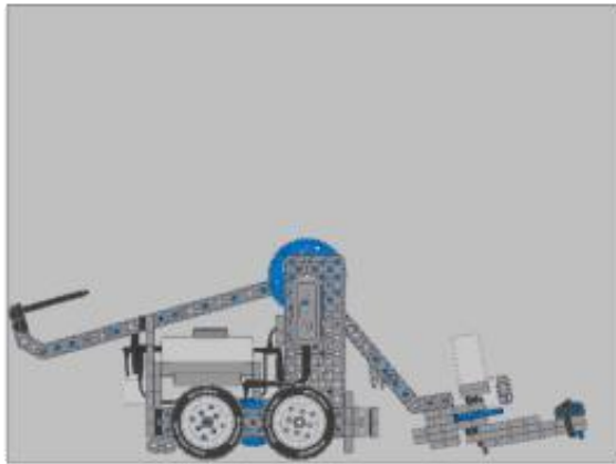
Рисунки 9 & 10 – Робот, начинающий матч с правильными размерами, и второй робот с неправильными габаритами из-за поднятого схвата.
