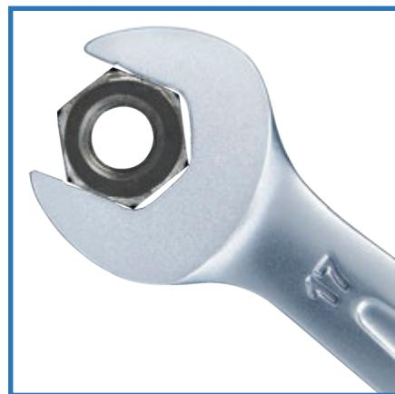
Так, например, гаечный ключ - рычаг второго рода. Опора этого рычага находится, по сути, на оси вращения гайки, нагрузка - на поверхности гайки, а усилие - на конце рукоятки. Плечо приложения нагрузки соответствует расстоянию от центра гайки до точки соприкосновения гайки и гаечного ключа. Плечо приложения усилия - от центра гайки до точки захвата гаечного ключа рукой. Очевидно, что, выиграв в силе, мы значительно проиграем в расстоянии.
