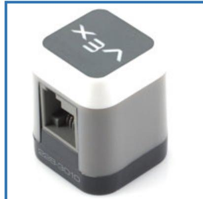
Расположим их сзади робота слева и справа. Их предназначение - предупреждать роботов, двигающихся позади, о маневрах идущего впереди робота. Если наш робот начнет останавливаться, оба датчика должны сменить цвет на красный; при повороте направо желтым цветом должен загореться правый датчик, налево – левый. При
